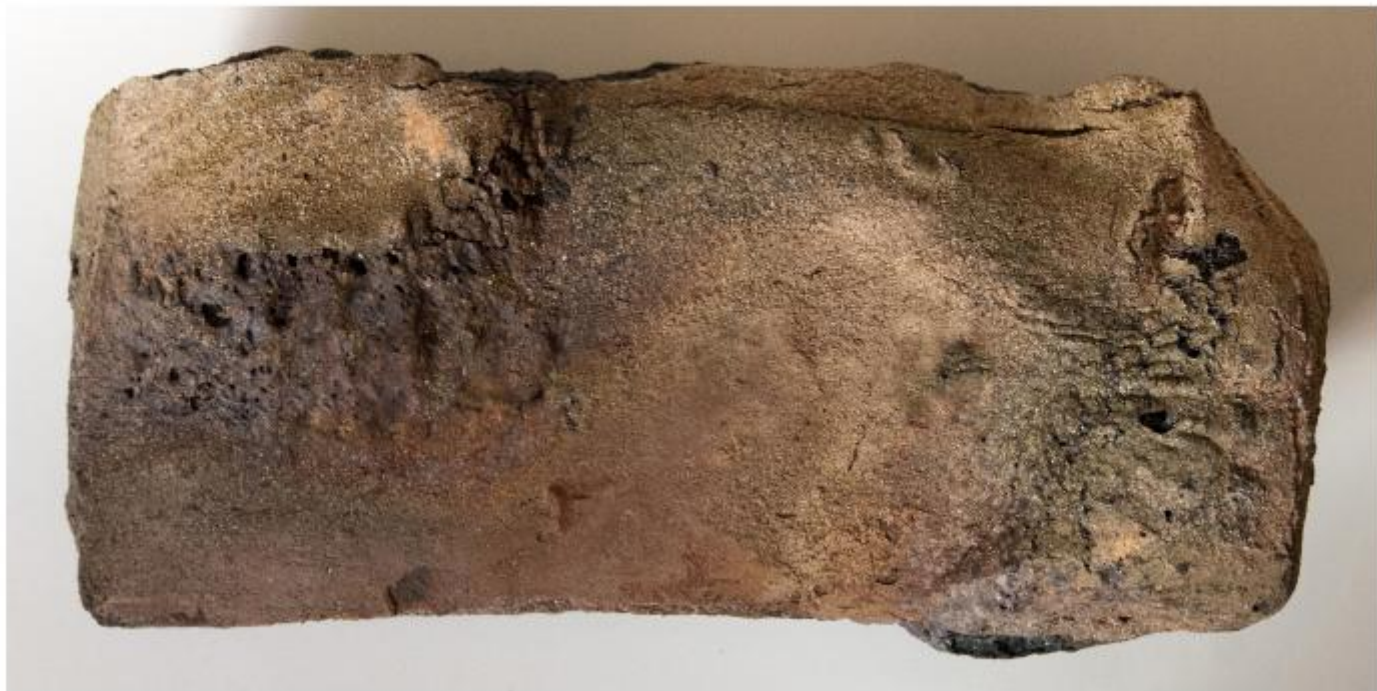
Mattone storto deformatosi al contatto con l'atmosfera
