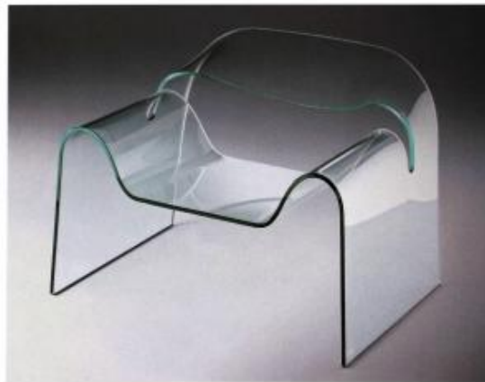
Cini Boeri, poltrona Ghost, 1987, Fiam La poltrona pseudo fatta a partire da un'unica lastra di vetro dello spessore di 12 millimetri, prima trince da un getto d'acqua ad alta pressione e alta velocità (1000 metri al secondo) con cui viene ricamato un unico taglio precisissimo e poi formata e colorata.
