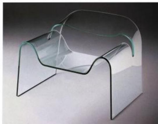
Cini Boeri, poltrona Ghost, 1987, Fiam La poltrona prende forma a partire da un'unica lastra di vetro dello spessore di 12 millimetri, prima incisa da un getto d'acqua ad alta pressione e alta velocità (1000 metri al secondo) con cui viene ricavato un unico taglio preciso e poi formata a caldo.
